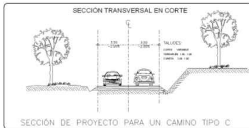
Figura 20. Sección transversal del tramo: Gabriel Zamora y Nuevo Urecho, del km 0+000 al km 42+000
