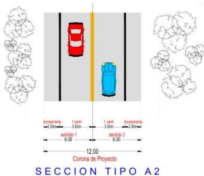
Figura 21. Sección transversal del Segmento 4, del km 0+000 al km 7+900
